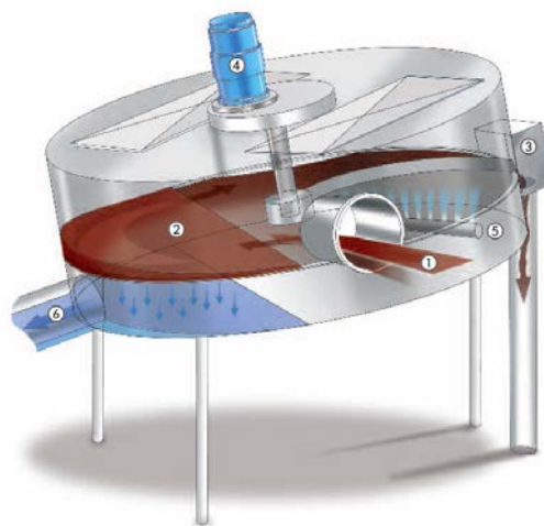
8.attēls. Dūņu blīvētājs – slīpi novietots rotējošs siets [6]
