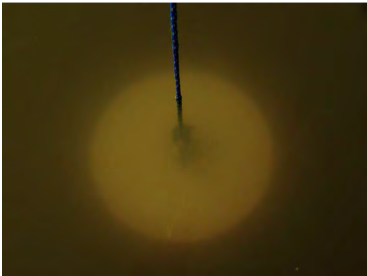
3.attēls. Lubāna ezers E085SP, Lubāna centrālā daļa, 10.09.2021. caurredzamība 0,45 m. Seki disks iegremdēts 23 cm dziļumā (foto: Vita Līcīte)
