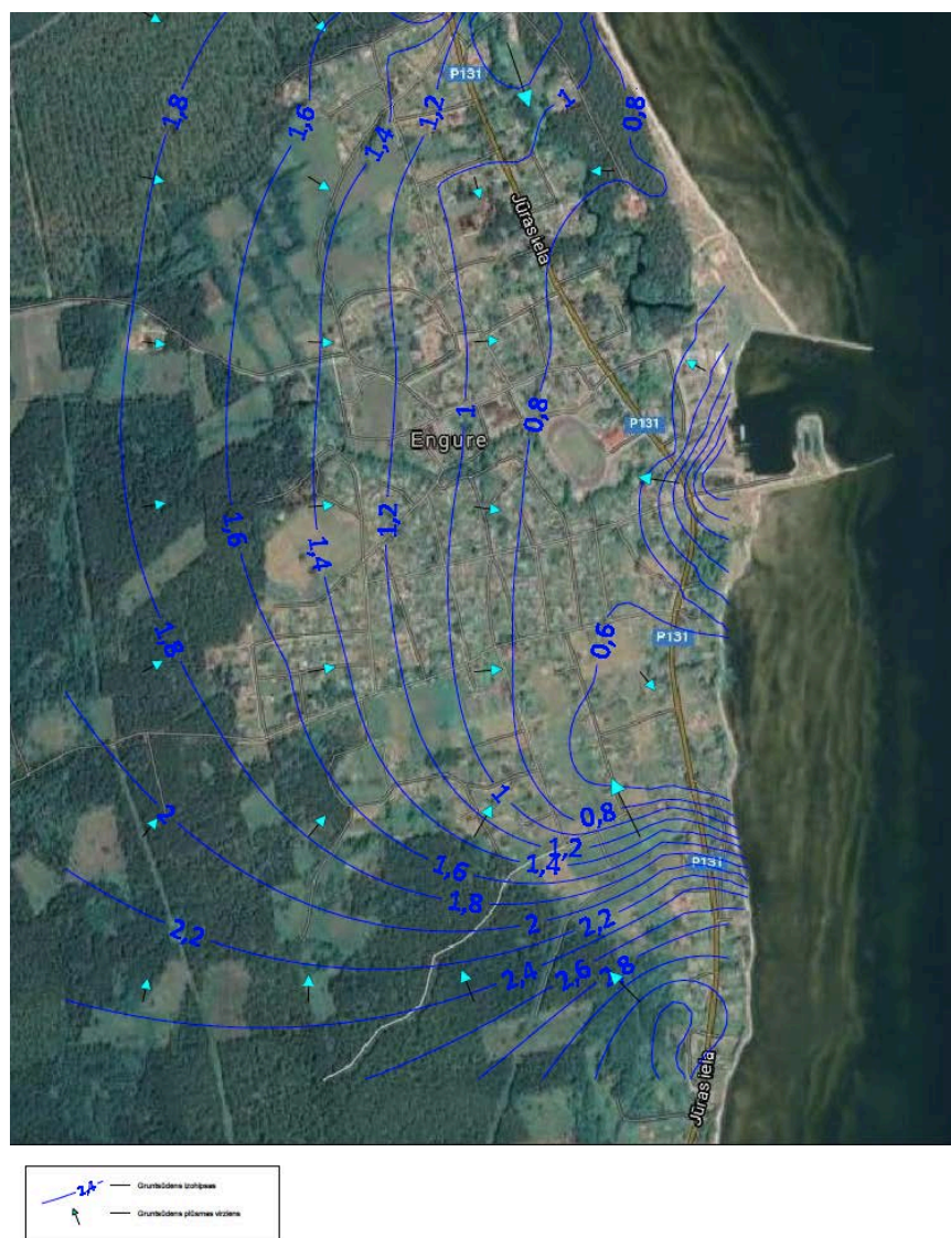
5.7. attēls. Engures ciema hidroģeoloģiskais gruntsūdens plūsmas modelis.
